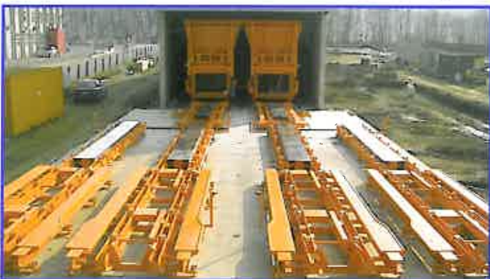
2 x MP6000 opération en parallèle avec transporteur à rouleaux pour conteneurs
