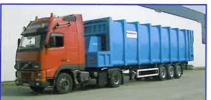
Semi-remorque avec bouclier d'éjection 60 m 3 charge utile environ 20 t
