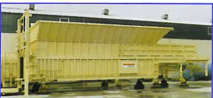
Compacteur de transbordement avec poussoir d'évacuation
